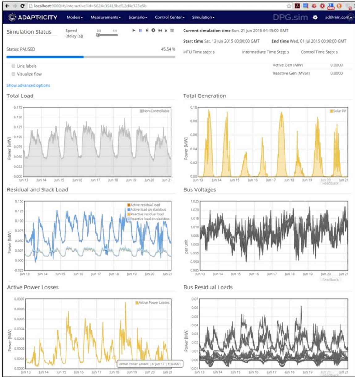
Figure 20 – Simulation of Kleinhüningeranlage in DPG.sim
